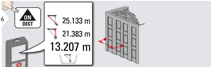
**i** El resultado se visualiza en la línea principal. Pulsando la tecla de medición durante 2 seg en la función se activa automáticamente la medición Mínimo o Máximo.
