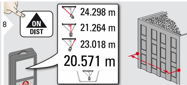
**i** El resultado se visualiza en la línea principal. Pulsando la tecla de medición durante 2 seg en la función se activa automáticamente la medición Mínimo o Máximo.
