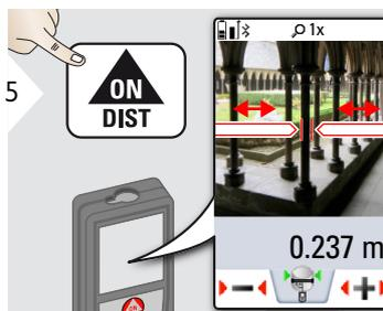
Seleccionar flechas con las teclas de cursos o pulsando en el display y ajustar con las teclas de función. Se calcula el diámetro correspondiente.
