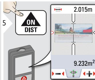
Seleccionar flechas con las teclas de cursos o pulsando en el display y ajustar con las teclas de función. Se calcula el área correspondiente.
