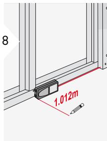
Mover el dispositivo lentamente a lo largo de la línea de replanteo. Se visualiza la distancia hasta el siguiente punto de replanteo.
