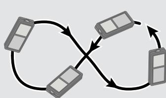
Girar el dispositivo lentamente en un movimiento que forme un ocho hasta que aparezca el icono OK en el display.
