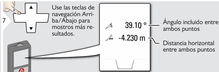
**i** Medición de distancia indirecta entre 2 puntos con resultados adicionales. Ideal para aplicaciones como la longitud e inclinación del techo, la altura de la chimenea en el techo, etc.
