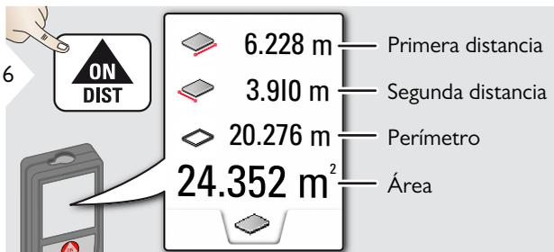
**i** El resultado siempre se mostrará en la línea principal y el valor medido encima. Mediciones parciales / función de pintar: Pulsar + o - después de iniciar la primera medición. Medir y sumar o restar distancias. Finalizar con =. Medir 2ª longitud.
