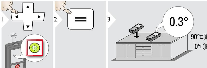
**i** Muestra las inclinaciones de 360° con una inclinación transversal de +/- 10°. Pitidos del instrumento a 0° y 90°. Ideal para ajustes horizontales o verticales.
